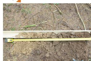
En bordure nord de chaque placeau flore, un sondage à la tarière, une description d'humus et un prélèvement de sol (sur 0-10 cm de profondeur) sont réalisés.
